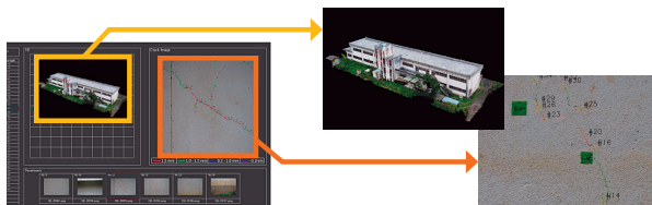
当社が開発したAIひび割れ判定システム「CrackVision」を活用
